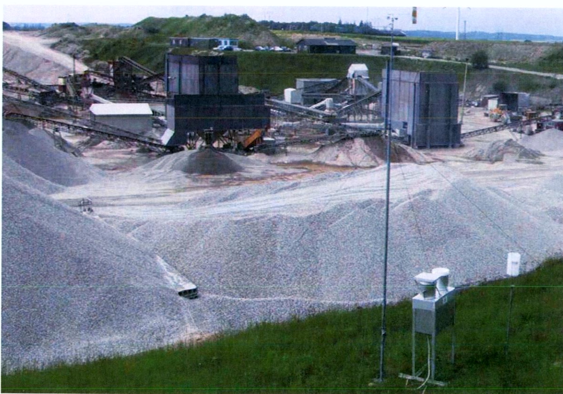
Måleudstyret METDUST udviklet af FORCE Technology til måling af nedfald af støv
